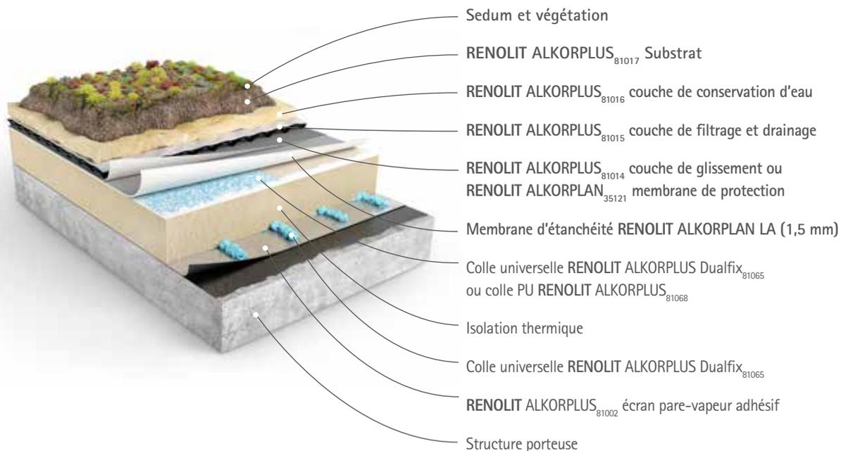
Le système RENOLIT ALKORPLAN Green est un système standard pour des toitures avec une inclinaison de 1° à 5°.
