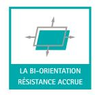
Processus de fabrication qui consiste à étirer les plaques dans les 2 sens créant ainsi un maillage dans la structure des molécules sans ajout d'additifs chimiques pouvant altérer le vieillissement des plaques.
